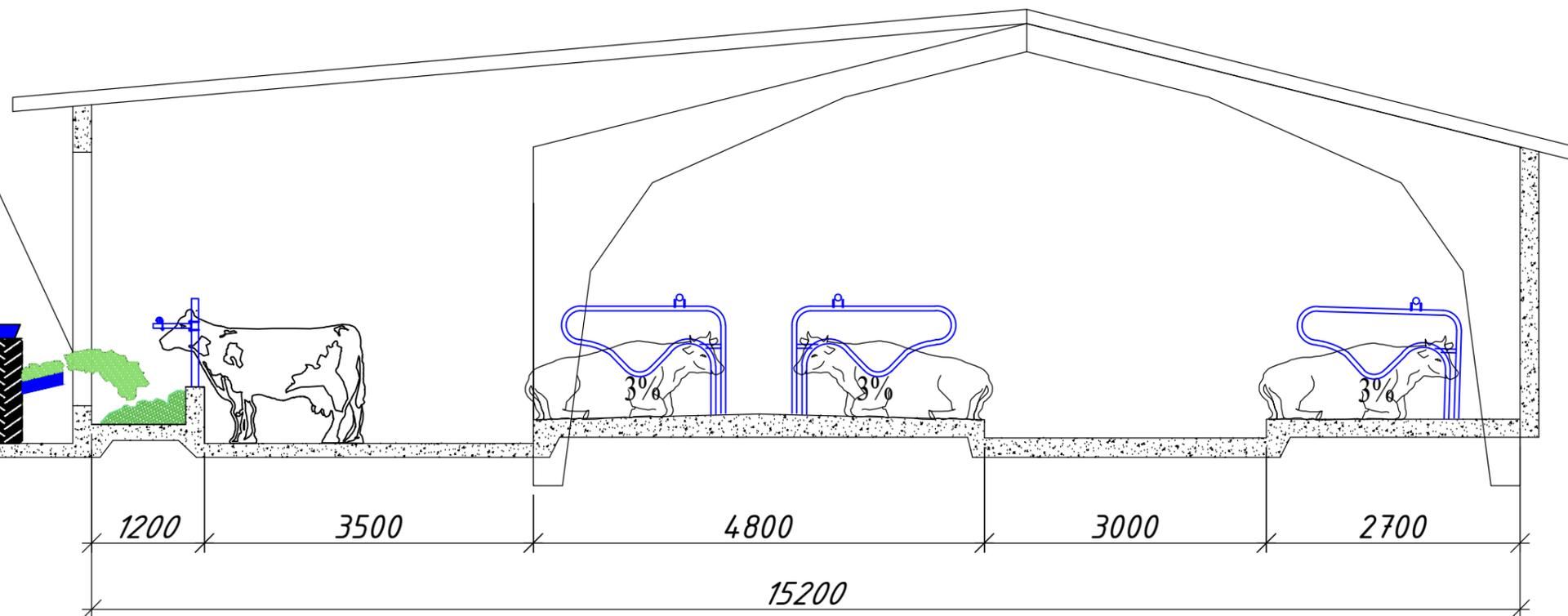
План и разрез коровника на 77 мест для дойных коров. Трафик предварительная сортировка
