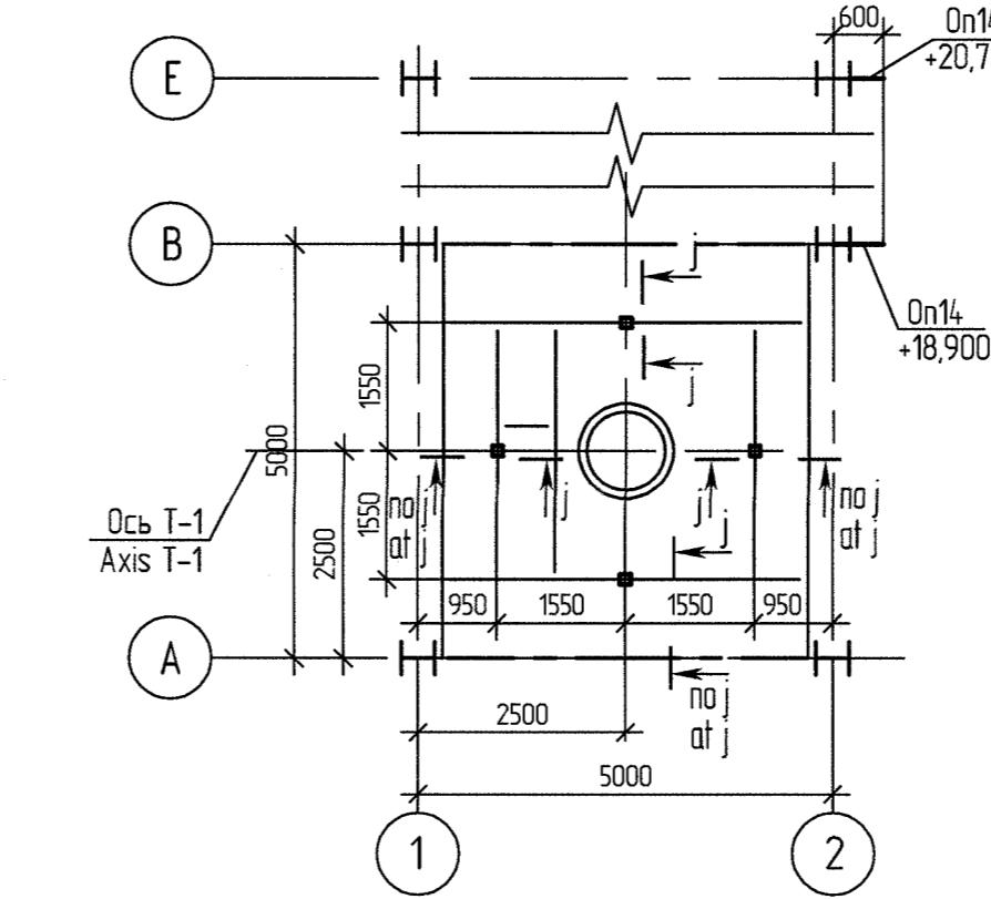
Схема расположения опор на отм. +21,310
