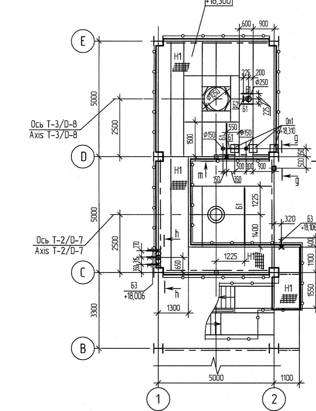
Схема расположения опор на отм. +18,900, +20,700
