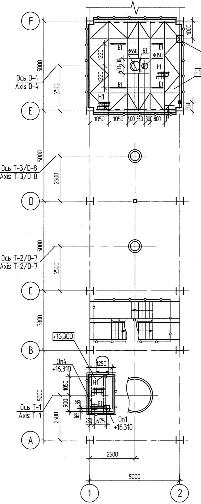
Схема расположения опор на отм. +18,310
