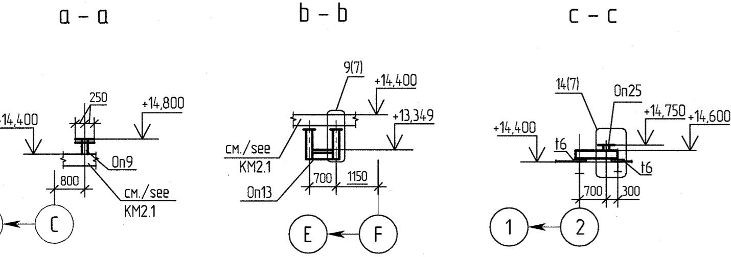
Схема расположения опор на отм. +16,310
