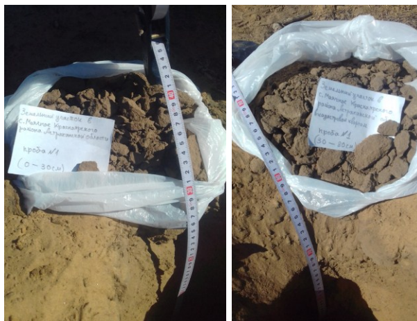
Рисунок 8. Закладка основных почвенных разрезов (горизонт 0-30 см; 30-80 см)
