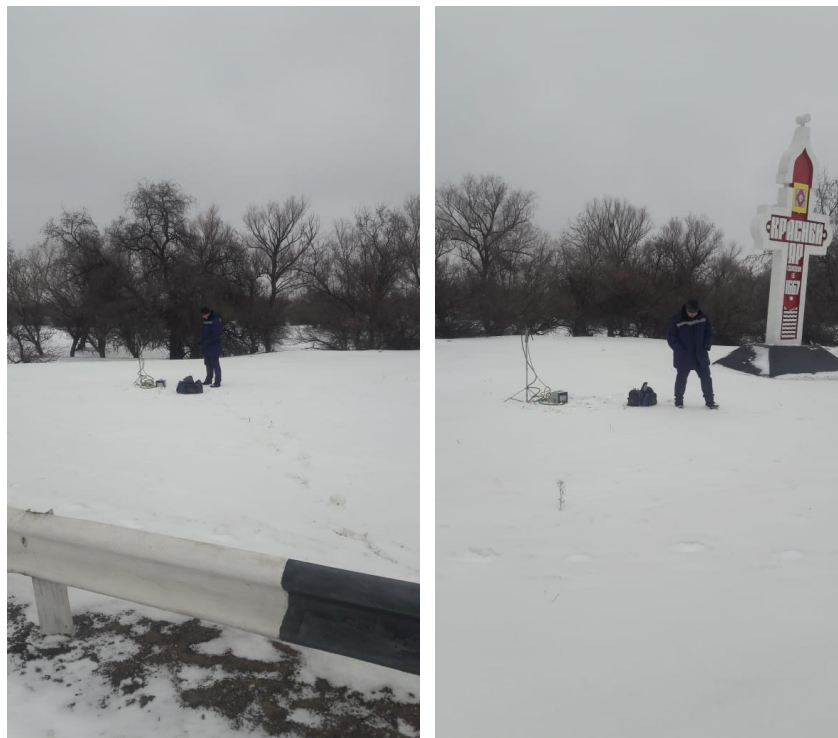
Рисунок 12. Замеры мощности дозы гамма-излучения и выявление локальных радиационных аномалий на территории инженерно-экологических изысканий
