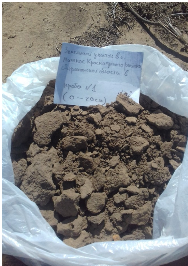
Рисунок 11. Отбор почвенной пробы на санитарные показатели с площадки под строительство с глубины 0-20 см
